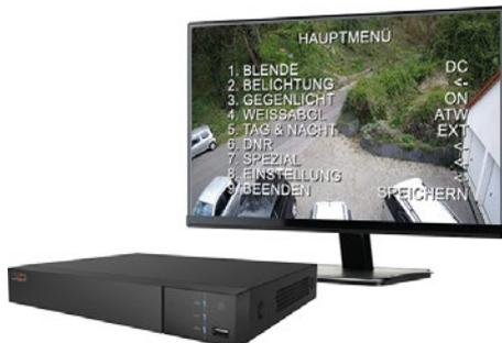
Die Kamera unterstützt UTC (Up The Coax). So können Sie in Verbindung mit einem kompatiblen Recorder oder mit einer passenden Einstelleinheit das Bildschirmmenü der Kamera auch über die Videoleitung konfigurieren. Es ist keine zusätzliche RS485 Verbindung erforderlich.
